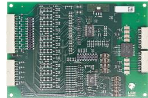
HV BMS Slave (LMM)
